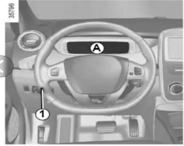
**Instrumententafel A:** wird beim Einschalten des Lichts beleuchtet. Die Helligkeit kann durch Drehen des Rändelrads **1** eingestellt werden. Beim Aufleuchten bestimmter Kontrolllampen erscheinen gleichzeitig Meldungen an der Instrumententafel.
